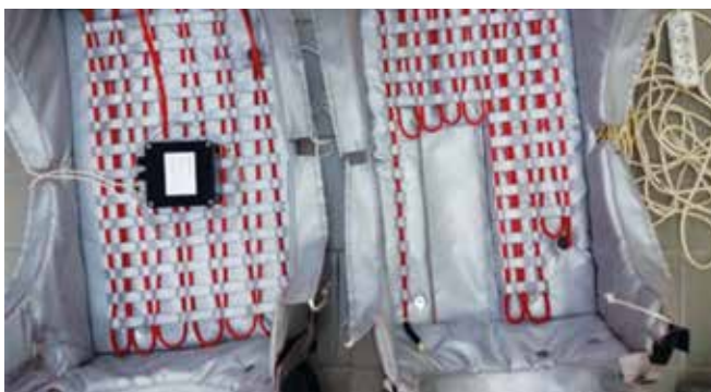
Fot. 2. Element grzewczy o dobranej mocy ułożony jest od strony wewnętrznej w pokrowcu termoisolacyjnym
