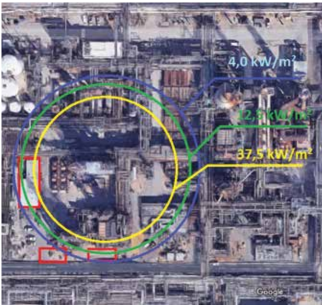
Rys. 2. Pożar strumieniowy, wypływ 100 mm
