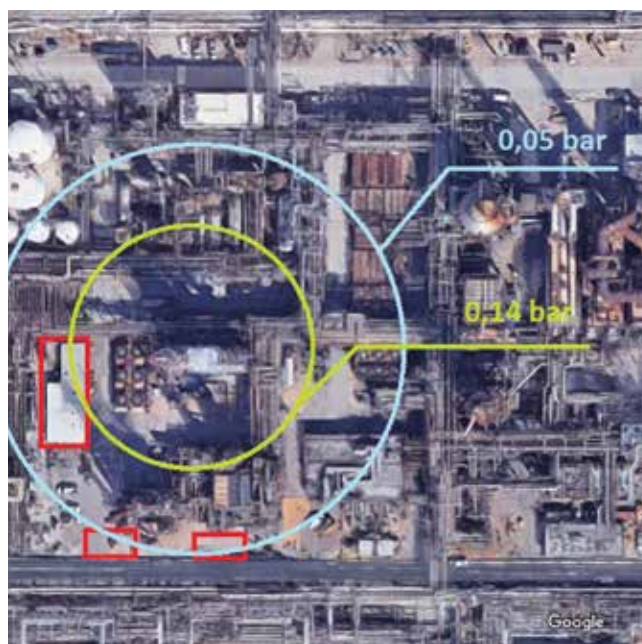
Rys. 1. Wybuch chmury parowej VCE, wypływ 25 mm
