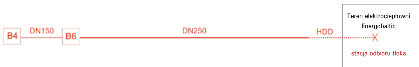
Rys. 2. Schemat odcinka 1. projektu – budowa gazociągu podmorskiego ze złóż B4 i B6 do elektrociepłowni Energobaltic we Władysławowie
