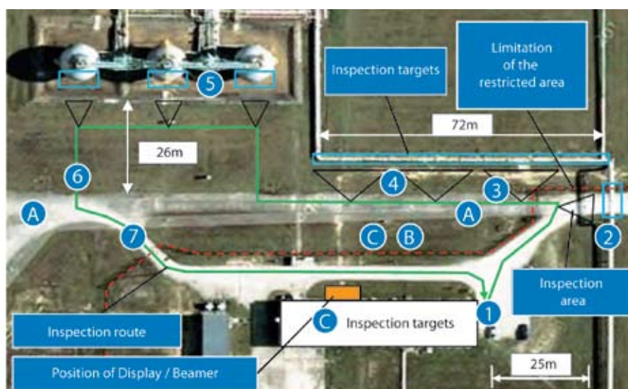
Rys. 8 Ostatni test w rafinerii PCK w niemieckim Schwedt mający na celu zademonstrowanie funkcji systemu RoboGasInspect (Źródło: Mapy Google)
