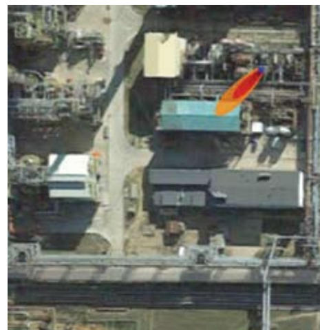
Rysunek 1. Określenie zasięgu tworzenia atmosfer wybuchowych w programie Effects. Pierwsze zdjęcie przedstawia zasięg atmosfery wybuchowej przy emisji wodoru, drugie – przy emisji mieszaniny gazów o składzie 40% H 2 , 30% N 2 , 20% CO, 10% CO 2 przy takim samym wypływie gazu
