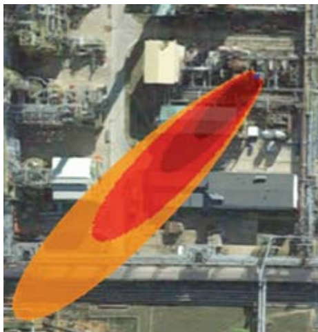
Rysunek 1. Określenie zasięgu tworzenia atmosfer wybuchowych w programie Effects. Pierwsze zdjęcie przedstawia zasięg atmosfery wybuchowej przy emisji wodoru, drugie – przy emisji mieszaniny gazów o składzie 40% H 2 , 30% N 2 , 20% CO, 10% CO 2 przy takim samym wypływie gazu
