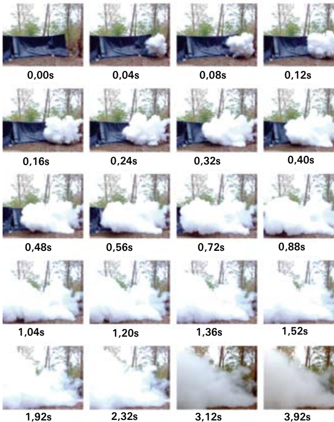
Rys. 16. Kolejne fazy procesu rozpylania proszku gaśniczego w otwartej przestrzeni przy użyciu gaśnicy o pojemności 10 dm 3 z ładunkiem prochu bezdymnego
