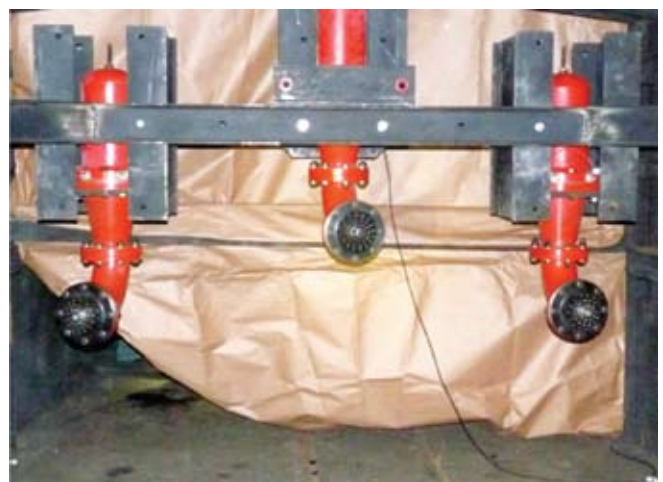
Rys. 19. Gaśnice gotowe do odpalenia na przodku wydobywczym Kopalni Doświadczalnej „Barbara”
