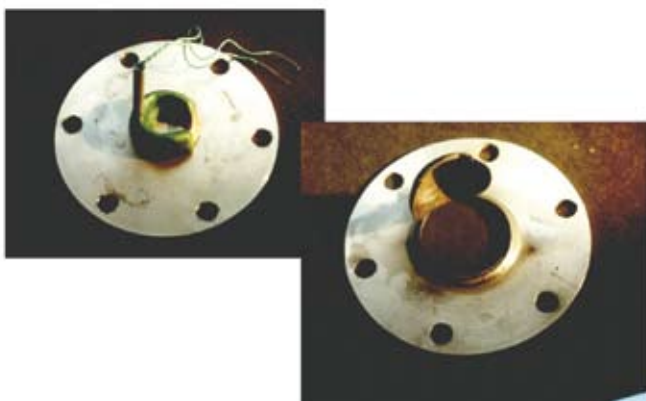
Rys. 5. Ładunek kumulacyjny przyczepiony do membrany (gotowy do działania) oraz wynik działania ładunku
