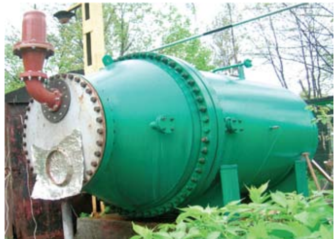
Rys. 17. Tłumienie wybuchu w komorze wybuchowej o objętości 5 m 3
