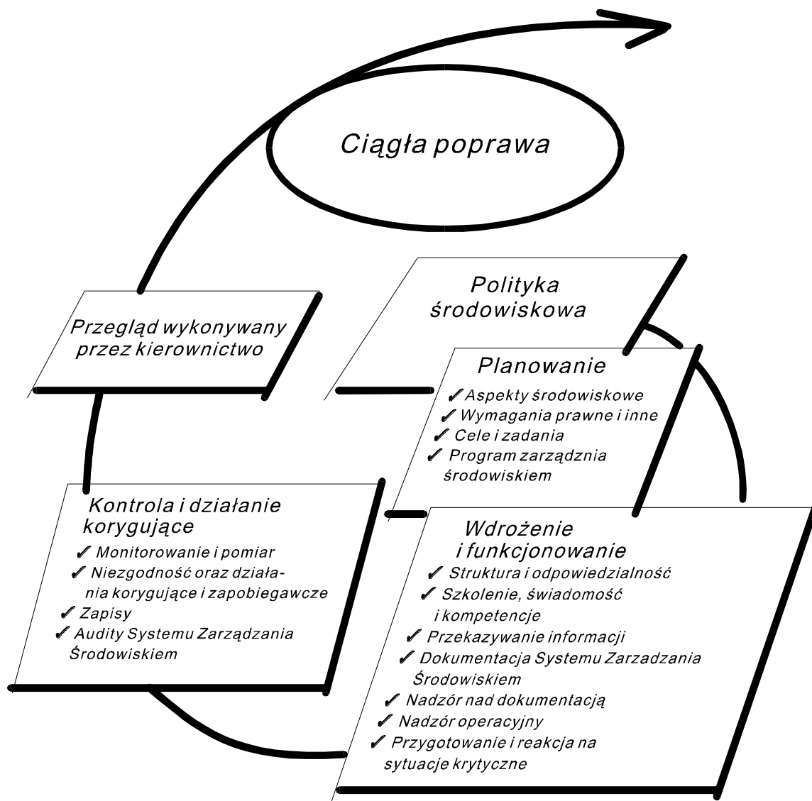
Rys. 5. Model systemu zarządzania środowiskowego wg ISO 14001
